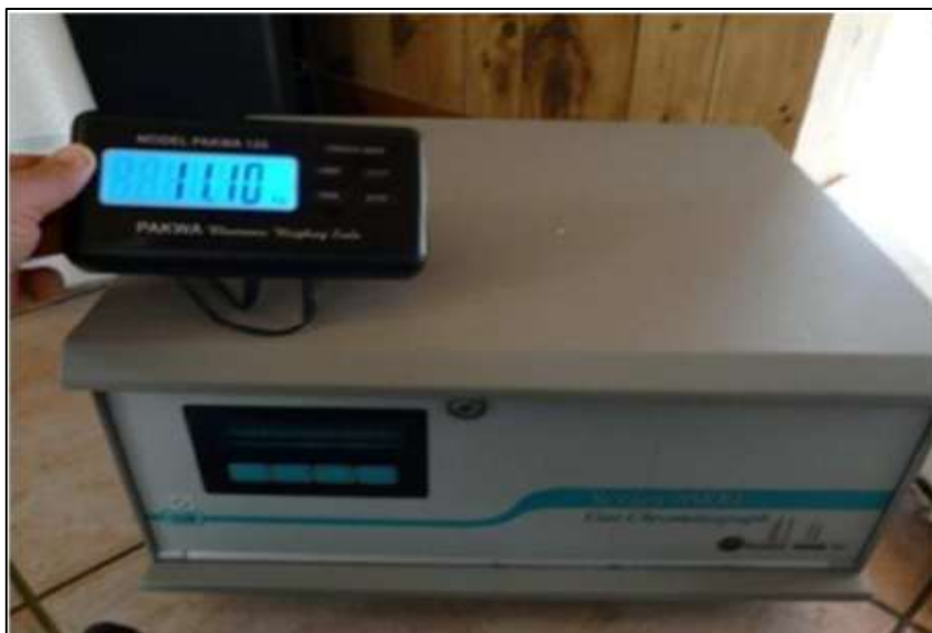
Figure III. 3: Analyseur transportable de BTEX (GC-PID) [29].
