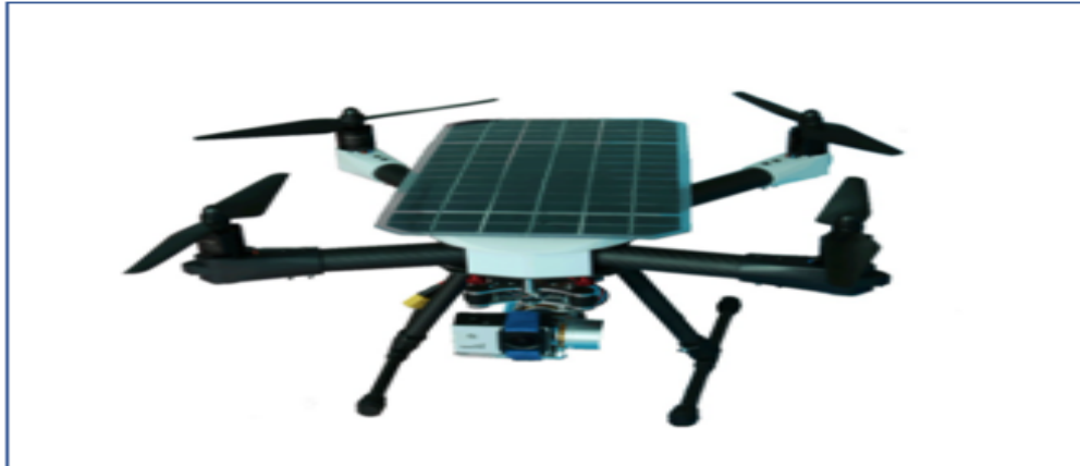
FIGURE 1.4: Capteur sans fil mobile basée sur la récupération d'énergie.
