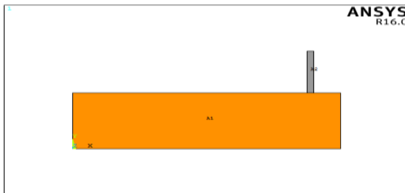
Figure III.9: Le système de la structure élancée fondée sur la couche de sol retenue.
