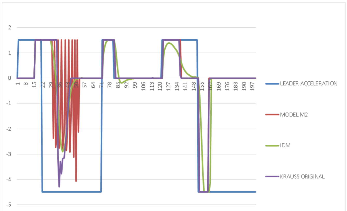
FIGURE 4.10 – Les accélérations des véhicules autonomes dans le Modèle non coopératif "ModelM2" et les approches "IDM" et "Krauss".
