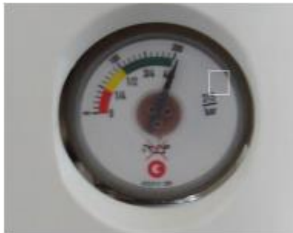
Figure III.3: Débitmètre intégré à bouteille d'O2 [45].
