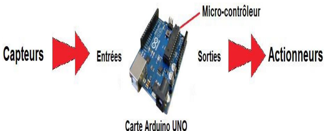
Figure II.18: La carte Arduino UNO. [41]
