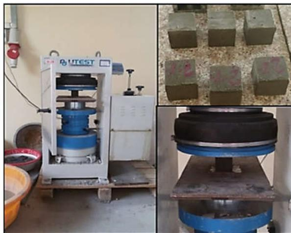
Figure II. 20 : Essai de compression [38].
