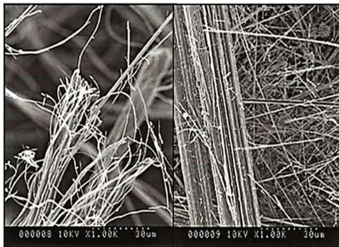
Figure I. 6 : Vue microscopique de fibres d'amiante [14].
