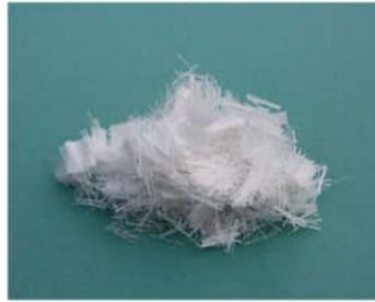
**Figure I. 9 :** Les fibres de polypropylènes.
