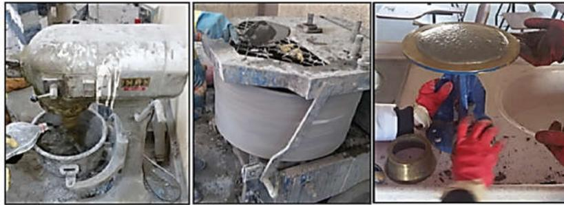
**Figure II. 18 :** Préparation des mélanges et essai de fluidité [38].
