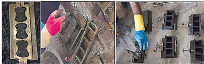
**Figure II. 19 :** Préparation des éprouvettes [38].
