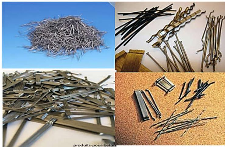
**Figure I. 10 :** Différentes formes de fibres métalliques [17].
