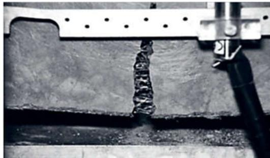
**Figure I. 11 :** Essai de l'ASTM C 1018 [19].
