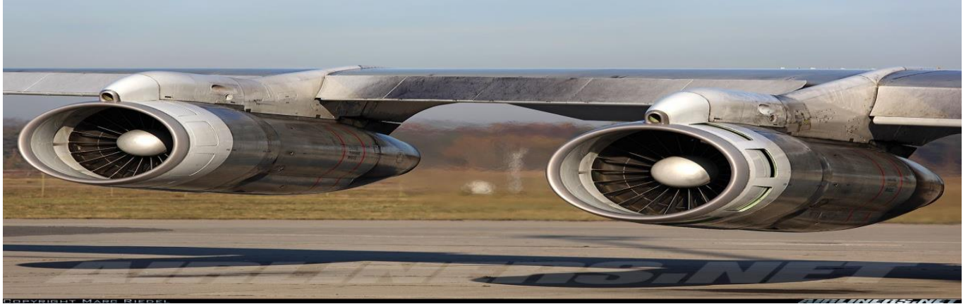
Figure I.9 : Avion Boeing 707 équipé d'un turboréacteur simple flux-Double corps
