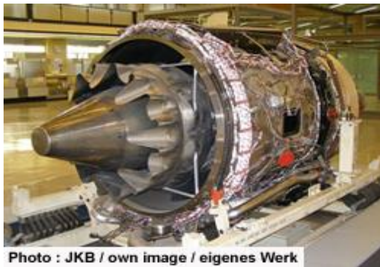
Figure II.35 : Mélangeur interne ondulé (Mixer)
