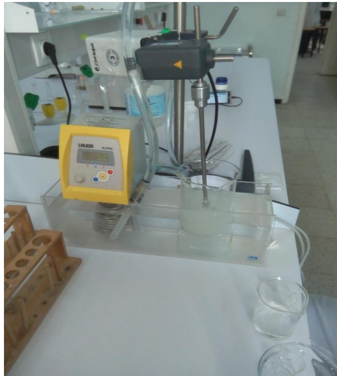
Figure II-2 : Installation de mise en œuvre du procédé d'adsorption.
