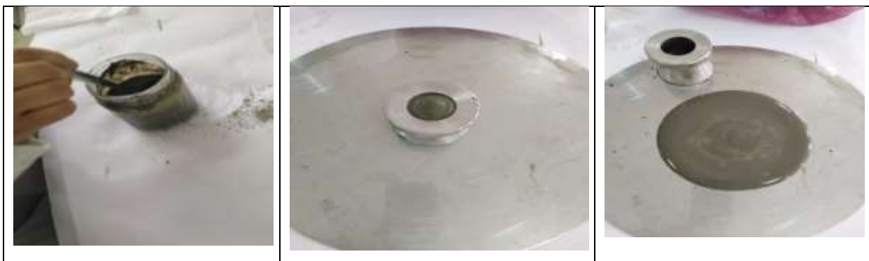
Figure 20. Détermination d'étalement : a. remplissage du mini cône, b. exemple d'étalement, d. cas de coulé ferme
