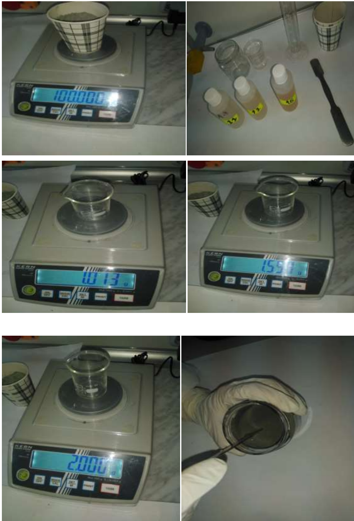
Figure 12. Mode opératoire de mélange ciment super-plastifiants.
