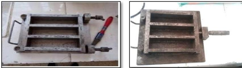
**Figure IV. 20:** Des moules prismatique  $(4 \times 4 \times 16)$  cm<sup>3</sup>.
