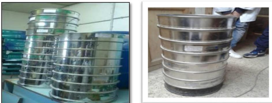
**Figure IV.6 :** séries des tamis en millimètres
