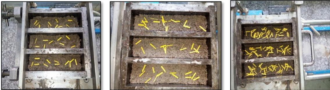
**Figure IV.24 :** La distribution des fibres courte dans les éprouvettes
