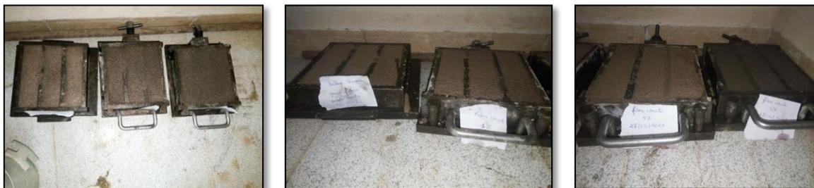
**Figure IV. 25 :** Les éprouvettes prismatique (4x4x16) cm<sup>3</sup>
