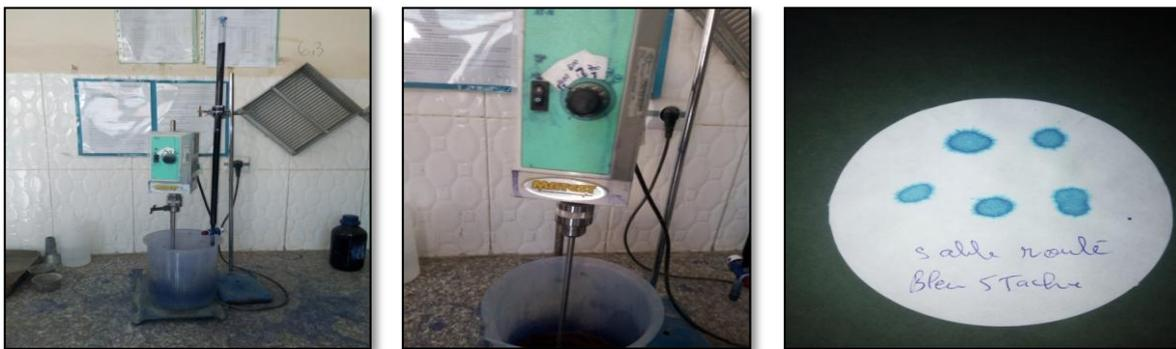
**Figure IV.9** : l'essai de bleu méthylène.
