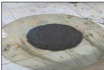
**Figure IV.14:** Essai d'étalement.
