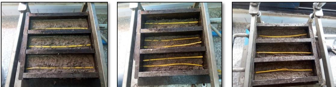
**Figure IV.23:** La distribution des fibres longue dans les éprouvettes
