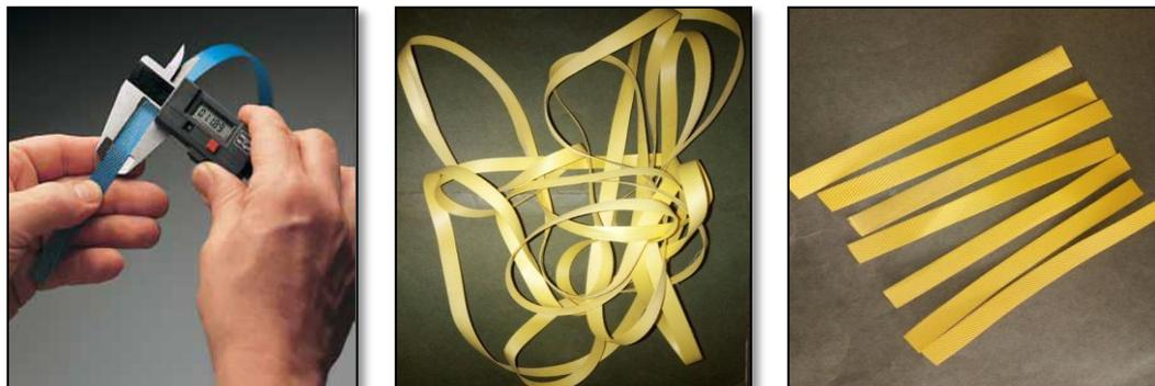
**Figure IV.12** : Le feillard polyester PET avant coupage à 16cm
