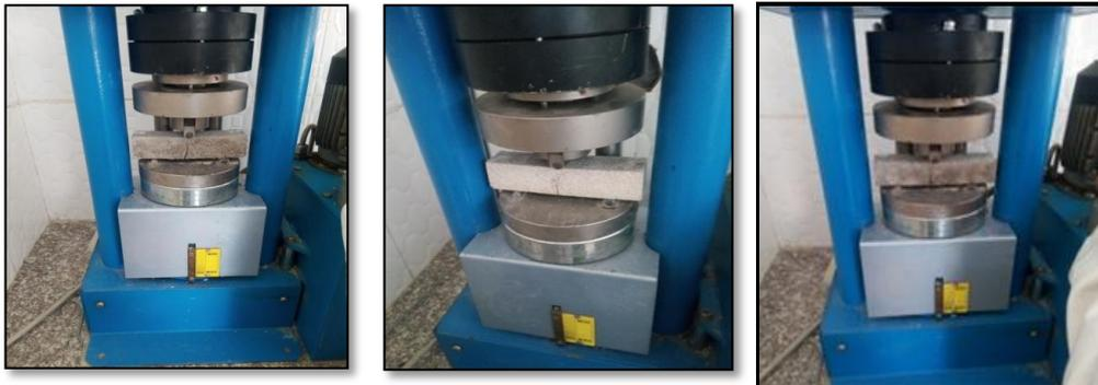
**Figure IV. 27 :** Essai de traction par flexion.
