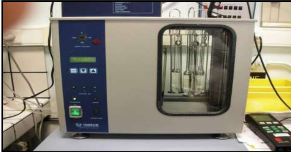
Figure IV.5: Viscosimètre de type Ubbelhodd ASTM D445.
