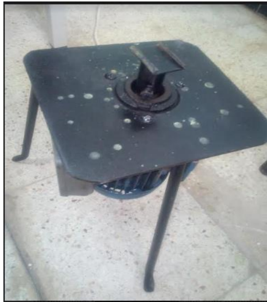
Figure II.1 : Photographie du montage expérimental de la tournette réalisée au niveau de laboratoire
