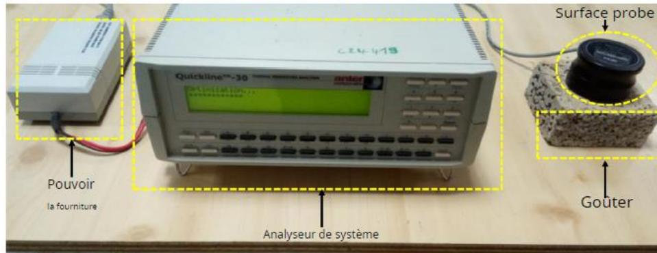
**Figure II. 6:** Détails du conductimètre QUICKLINE-30[20]
