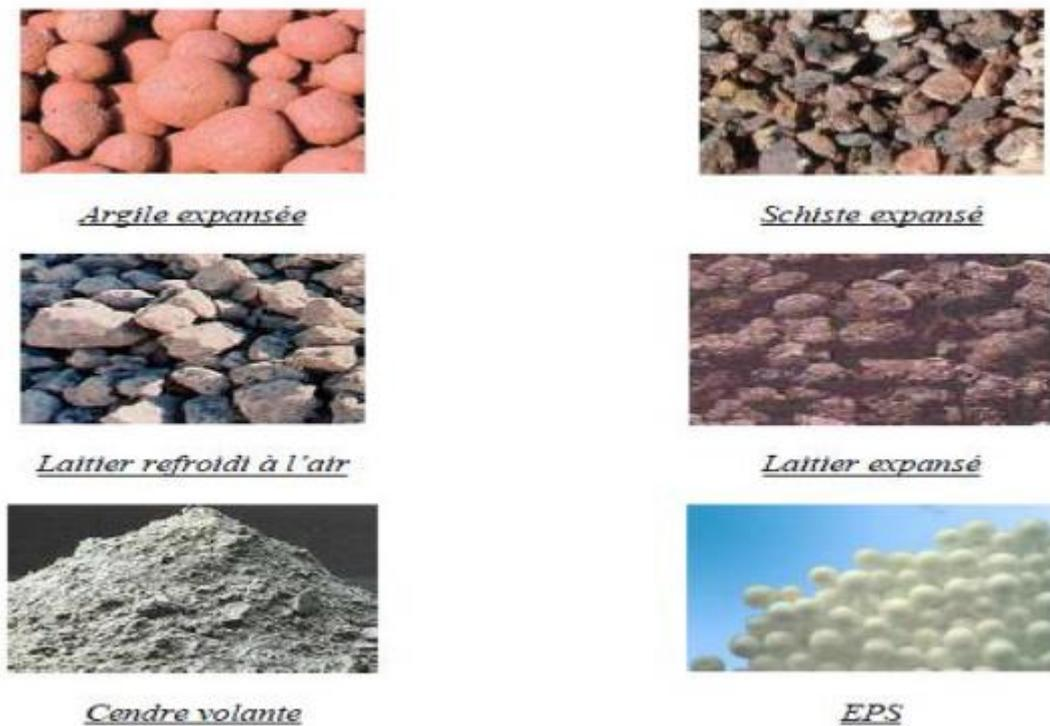
**Figure I. 3:** Différents granulats légers artificiels [4]
