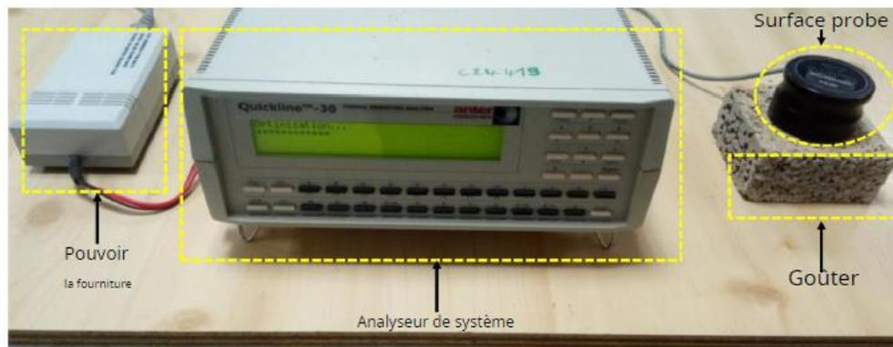
**Figure III. 9:** Conductimètre
