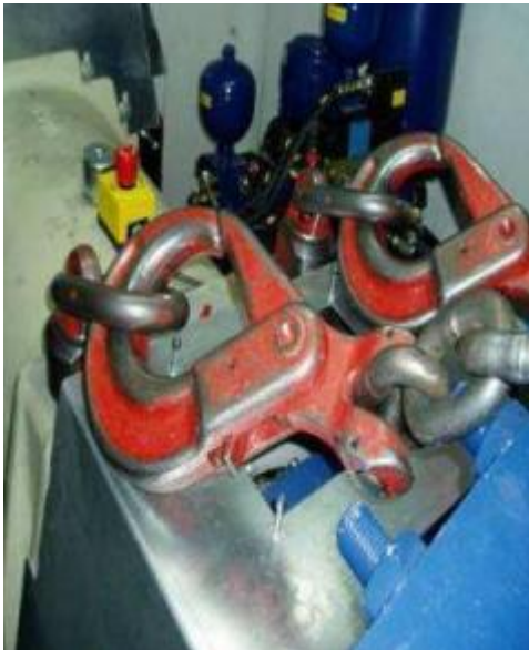
Figure IV.18 Crochets du harnais avant sur l'arrière de l'outil d'élévation.
