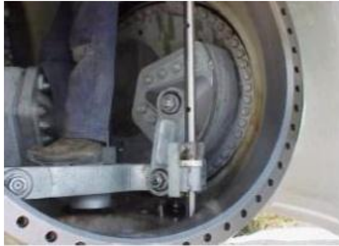
Figure IV.24 Fixation la bielle entre la pale et l'étoile
