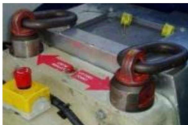
Figure IV.16 Assemblage des boulons à œillet M45 sur le cadre chevalet
