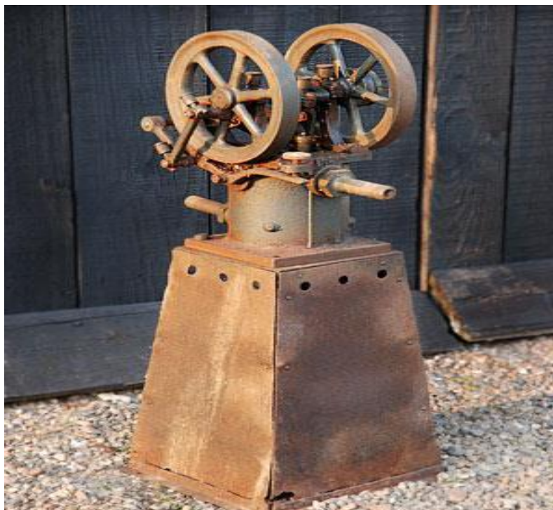
Figure I.2 : L'une des premières réalisations de moteur Stirling [2].
