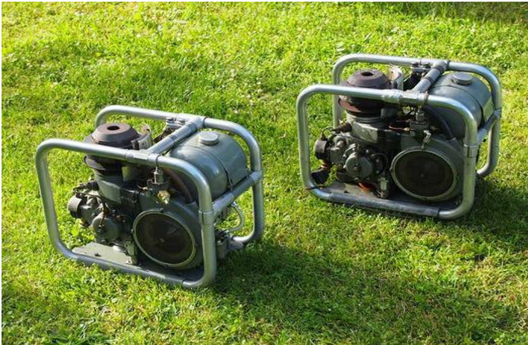
Figure I.3 : Groupe électrogène à moteur Stirling de 180 W développé par Philips dans les années 1950 [2].
