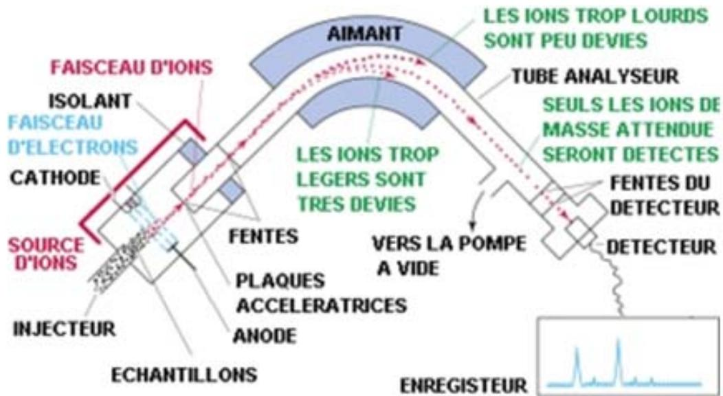
FIGURE 2.2: schéma de principe de la spectrométrie de masse
