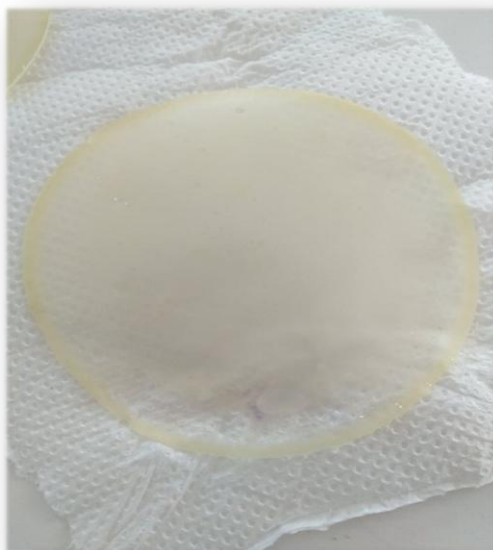
Figure (II-1) : Film membranaire issu à partir du polystyrène modifié par acide oléique en présence de l'huile de lin.
