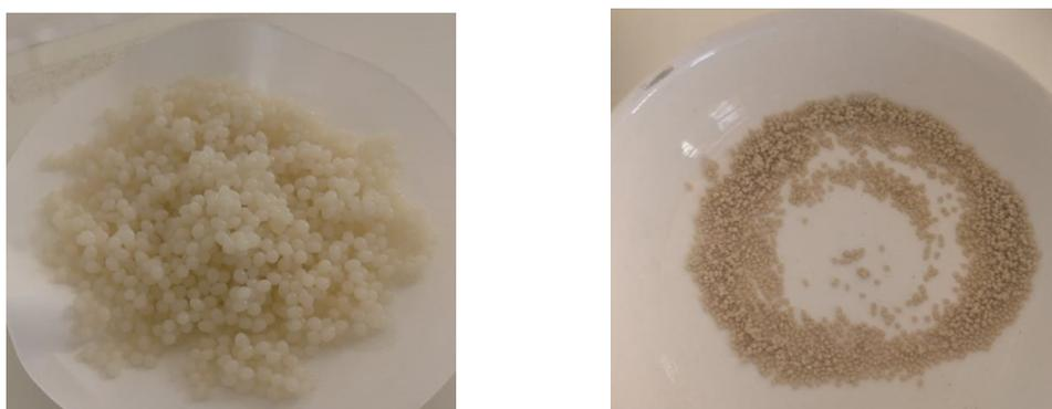
**Figure II. 3.** les billes d'alginate/ Bentonite avant et après séchage.
