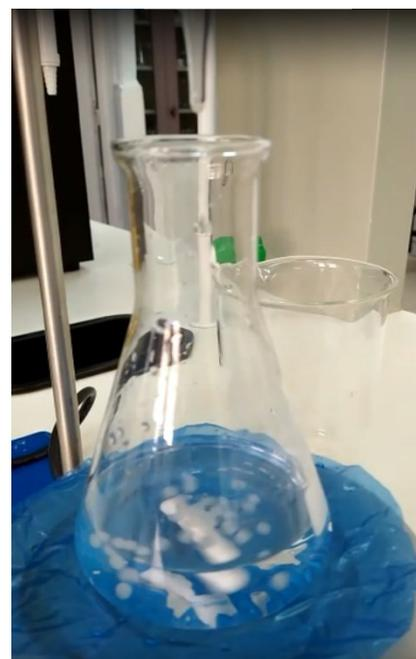
**Figure II. 1** .Préparation des billes d'alginate de sodium .
