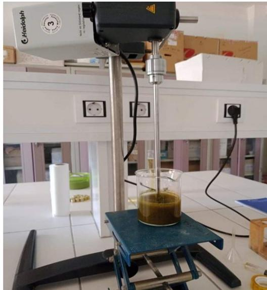
*Figure. III.9 Un agitateur mécanique.*
