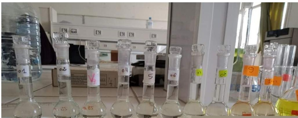
*Figure III.5 Les différentes solutions de la courbe d'étalonnage.*
