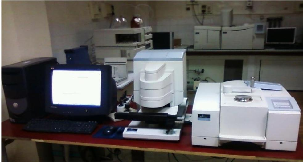
*Figure III.7 Un Spectrophotomètre Infrarouge.*
