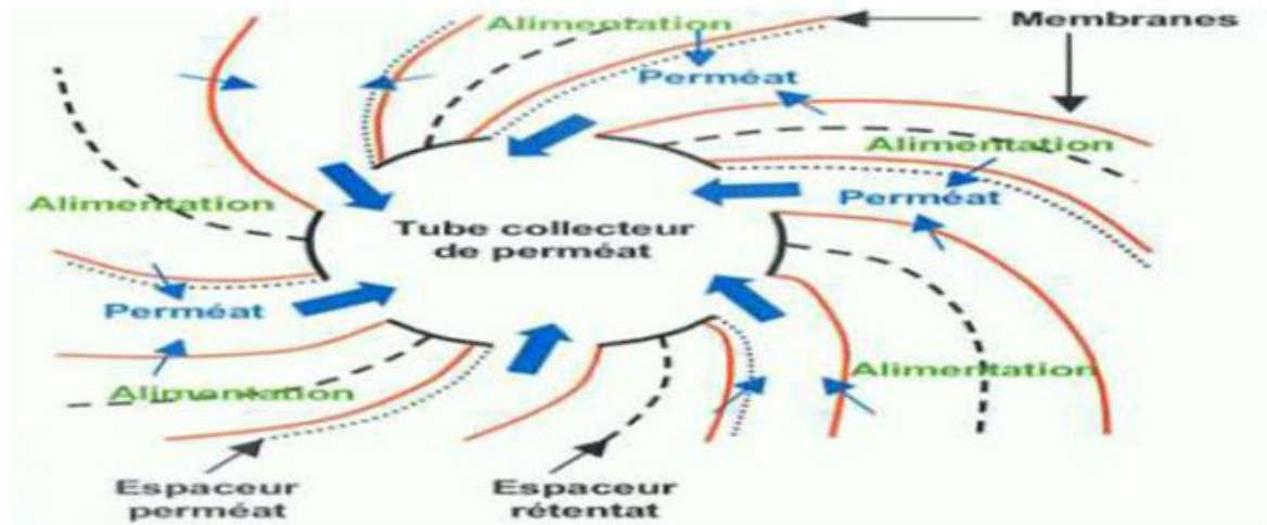
Figure I.13 : Principe de fonctionnement d'une membrane spirale vue en coupe.
