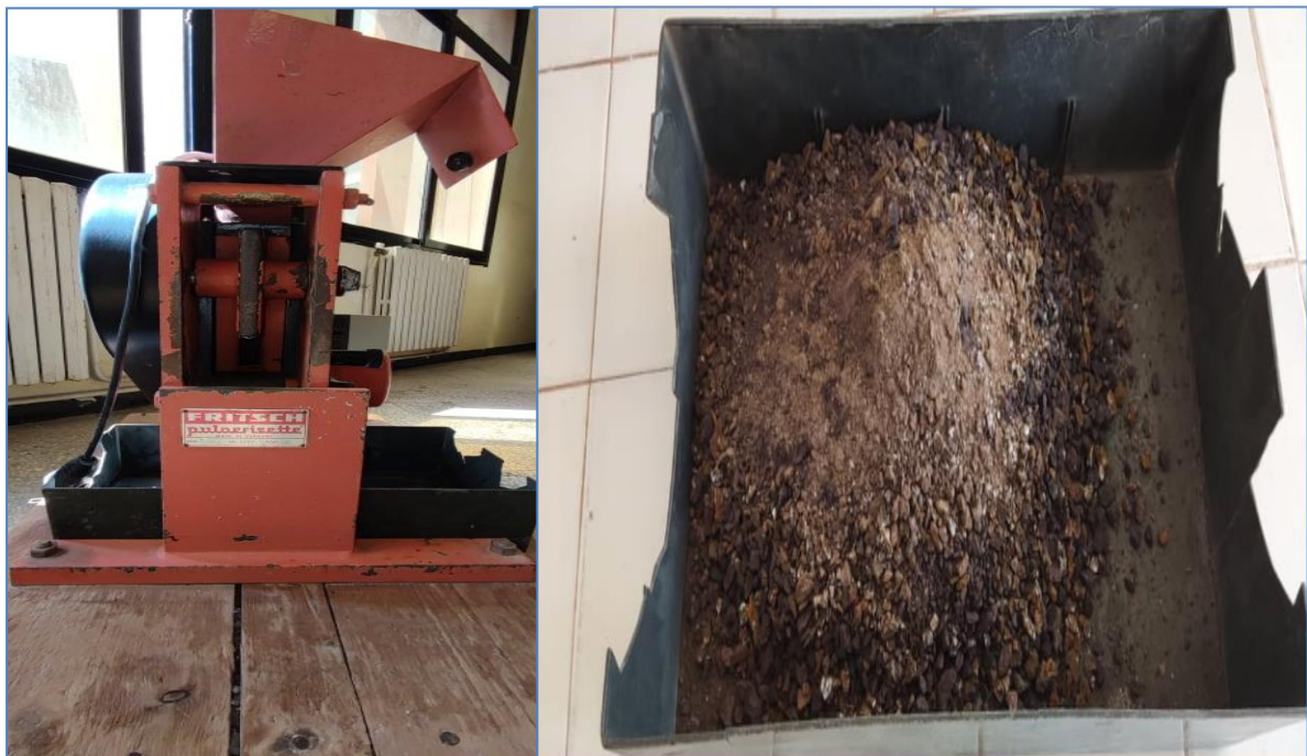
Figure II.2 : Concasseur à mâchoire
