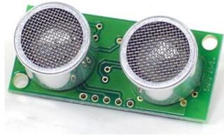
FIGURE 1.2 – Exemple d'un capteur qui mesure la distance
