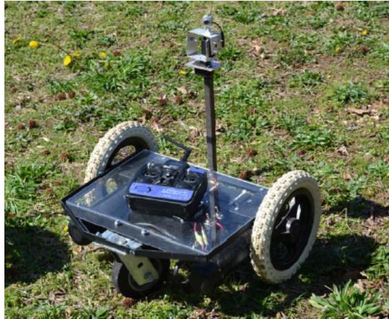
FIGURE 1.7 – Robot de type voiture [6].
