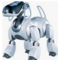
FIGURE 1.6 – Robot Mobile à patte
