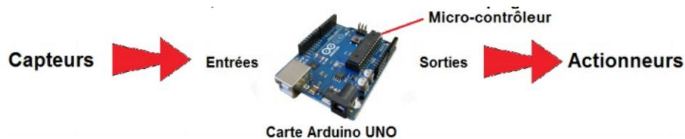
FIGURE 2.1 – Principe de fonctionnement d'une carte Arduino [9]
