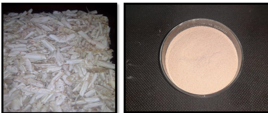
Figure III. 1 : Carapaces de crevettes avant et après broyage.
