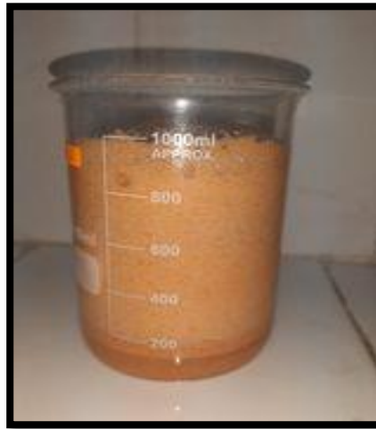
Figure III.2 : Déminéralisation des carapaces de crevettes par HCL 2N.
