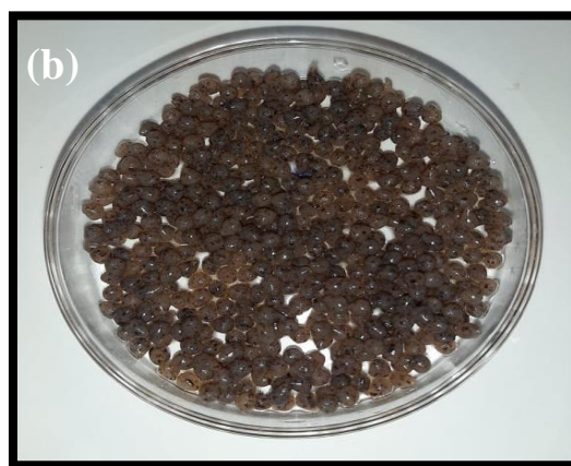
Figure IV. 8 : Photographie numérique des billes de chitosane et les billes composite (chitosane/marc de café) réticulées par l'épichlorohydrine.
