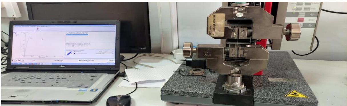
Figure IV. 9. Test de traction des fibres végétales
