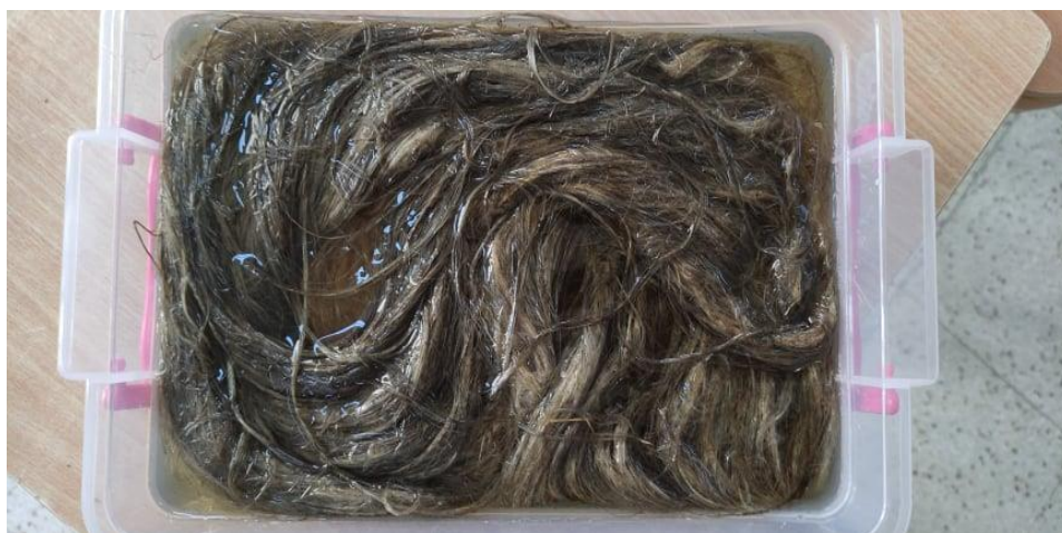
Figure IV. 2..Fibres de lins dans NaOH (0.5% - 1%)
