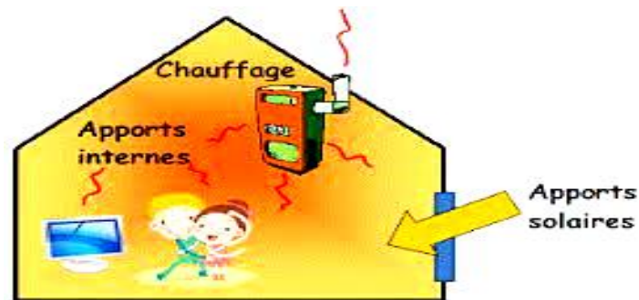
Figure II.1. Apports énergétiques (intérieurs et extérieur)
