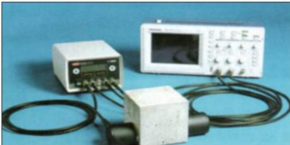
Figure IV.5: appaillage d'auscultation soniques 58-E48 avec oscilloscope [24]
