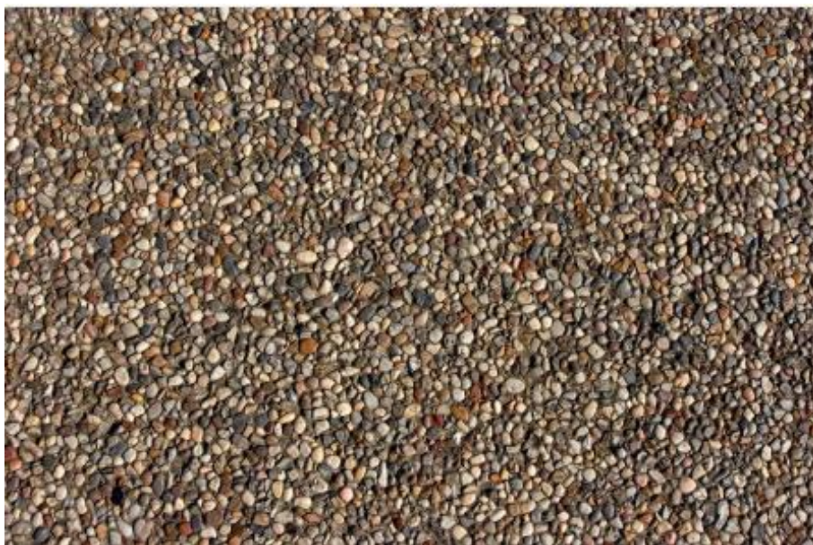
Figure II.3 : Terrasse en béton désactive [16].
