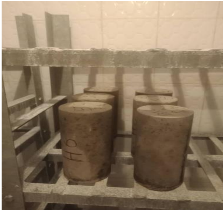
Figure I.4 : éprouvette de béton ( \Phi=16 cm, h=32 cm) dans un milieu humide.
