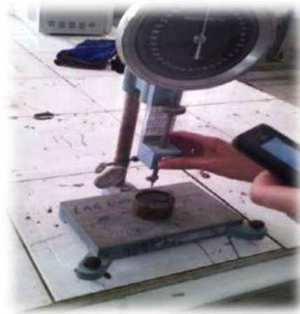
Figure III.6: Dispositif de l'essai de pénétrabilité à l'aiguille
