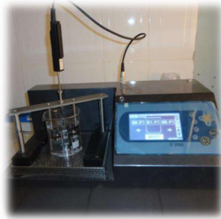
Figure III.7: Appareil digital de ramollissement (Bille et anneau)
