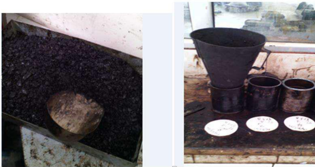
Figure IV.6: Remplissage des moules Marshall
