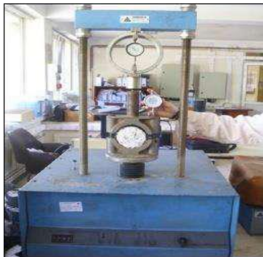
Figure IV.10 : Ecrasement des éprouvettes
