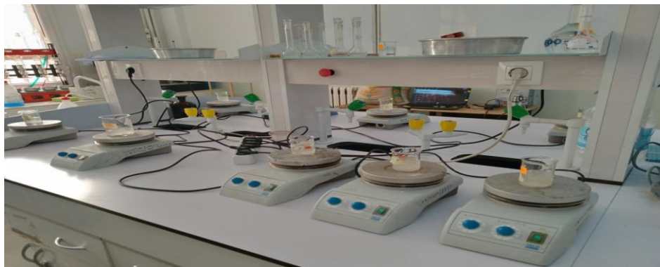
Figure III.4 : Dispositif expérimental pour la détermination du \text{pH}_{\text{PZC}} .
