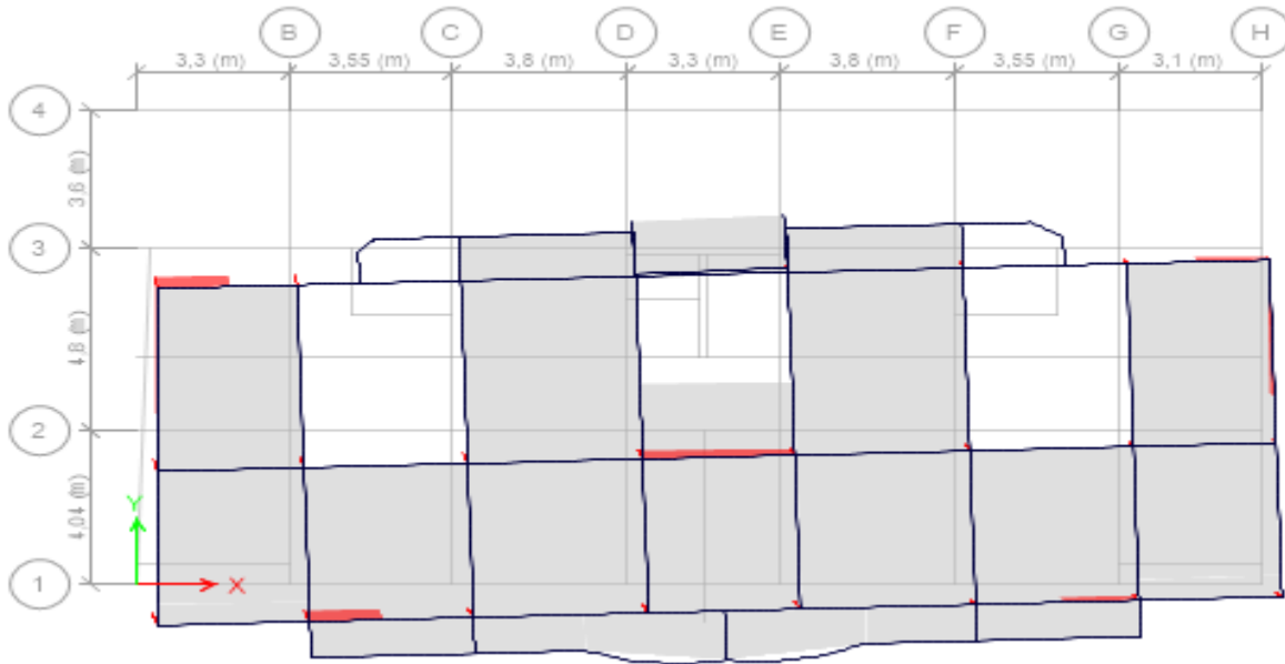
Figure IV.3. Premier mode de déformation (translation suivant Y) (T=0.52s)
