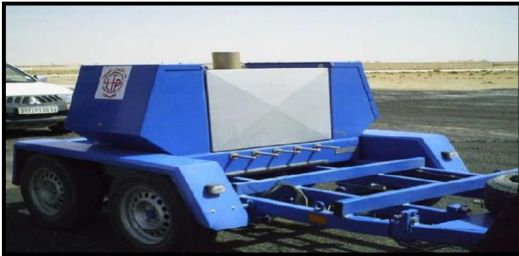
Figure III.7 Illustration de HWD modèle 8082-86
