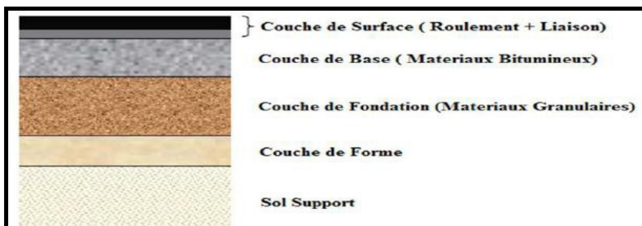
FigureIV.1 Illustration d'une structure de chaussée souple
