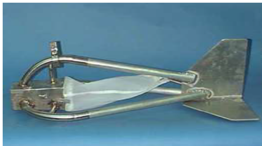
Figure I. 6 : Echantillonneur du transport solide en charriage avec différence de pression à l'entrée [5].
