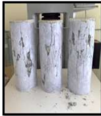
Figure.II.12 Ruptures des échantillons [20].compression
