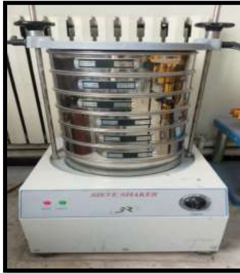
Figure.III.4 L'analyse granulométrique par tamisage
