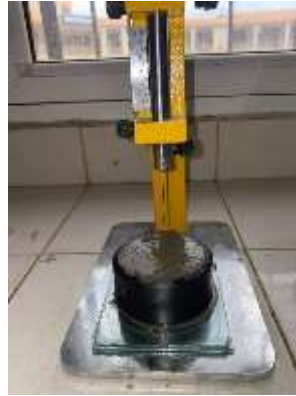
Figure.III.3 L'appareil de Vicat
