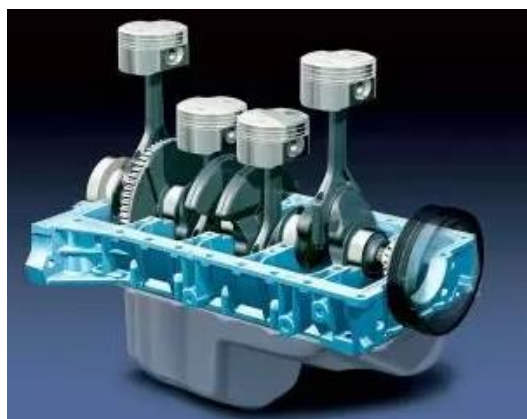
Fig II.1 Schéma de principe MCI à piston alternatifs[13]
