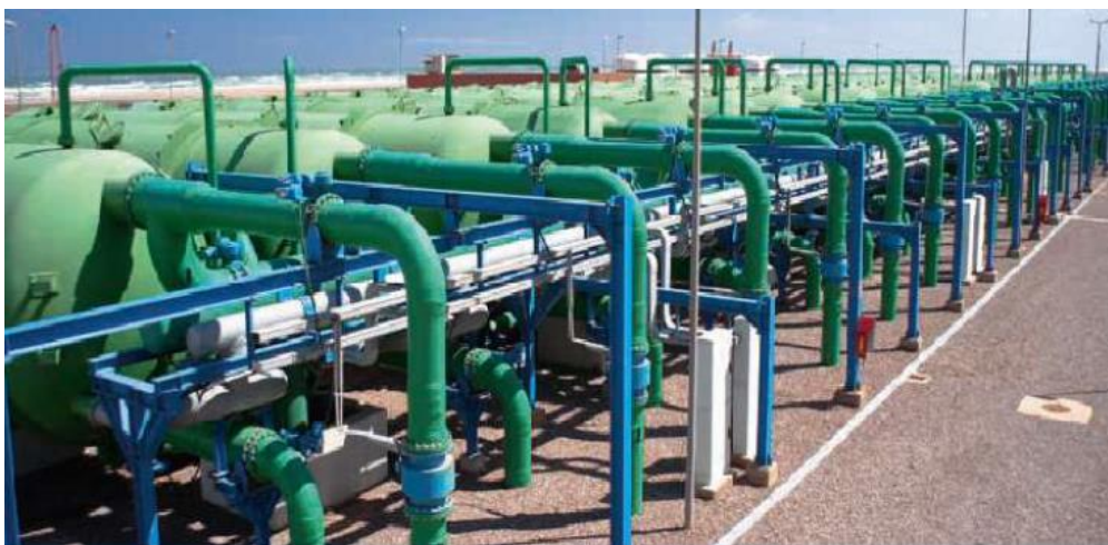
Figure 22 : Filtres à sable et anthracite
