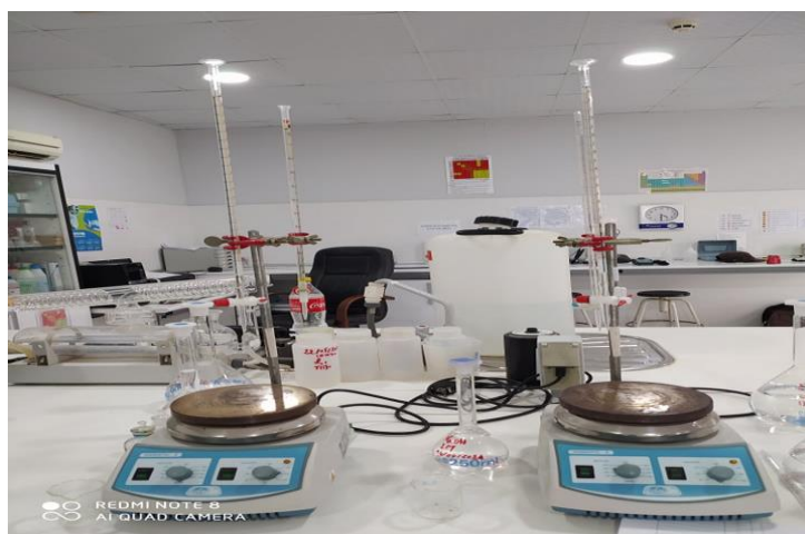
Figure 30 : Titrage par la solution d'EDTA
