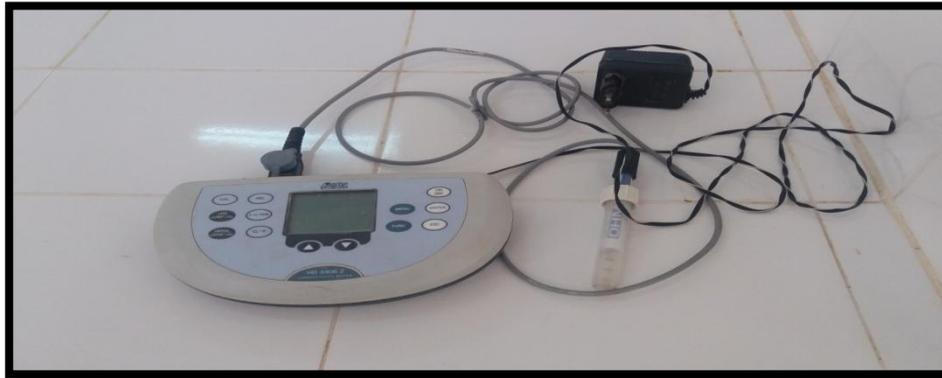
**Figure IV.4 :** Appareil de conductivimètre
