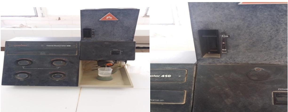
**Figure IV.5 :** Appareil de flamme photomètre 410 pour mesure les cations
