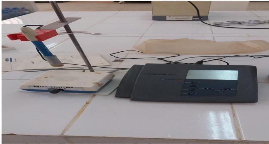
**Figure IV.3 :** Appareil WTW 720 de pH température
