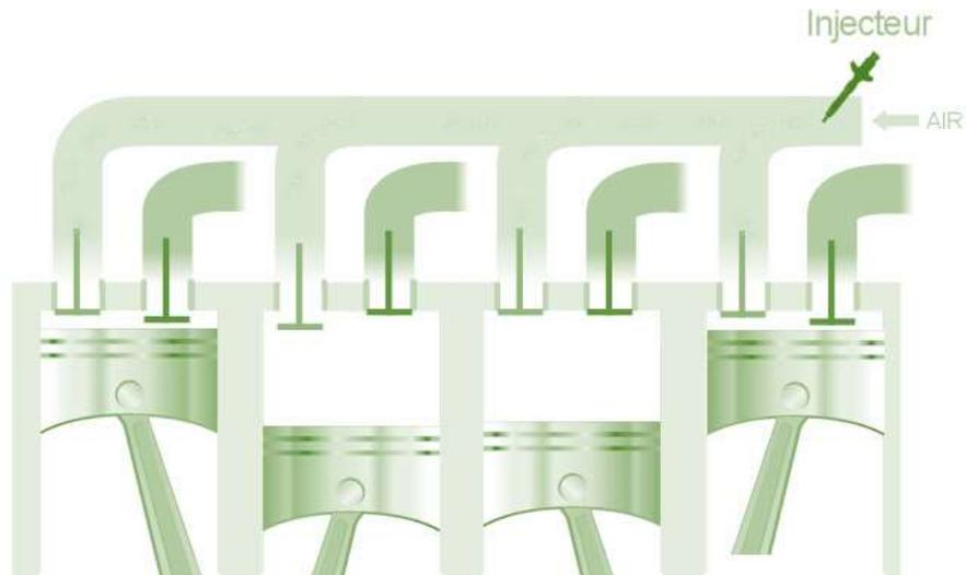
Fig.1.2 : Injection MONOPOINT (un seul injecteur envoie le carburant dans la tubulure) [3].
