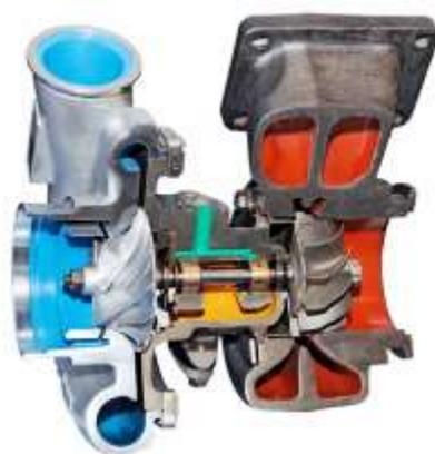
Fig.III.1 : coupe d'un Turbo[3]
