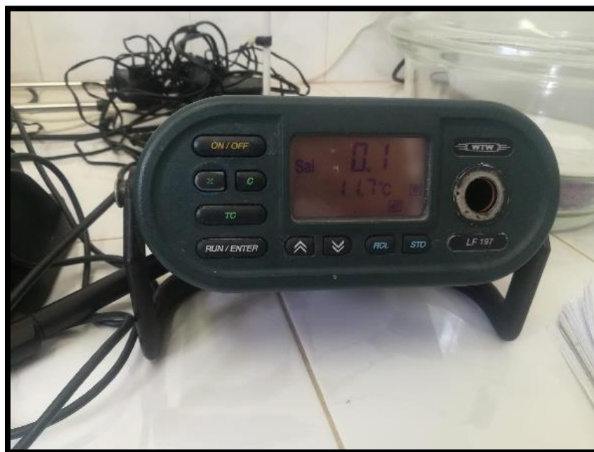
Figure IV.1: conductimètre WTW Conductimètre LF 197 (Photo prise par BENSEDIRA S., 2020).
