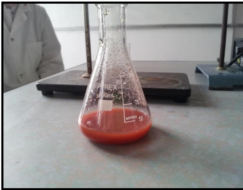
Figure IV.4 : Le résultat du virage de \text{Cl}^- (Photo prise d'internet).
