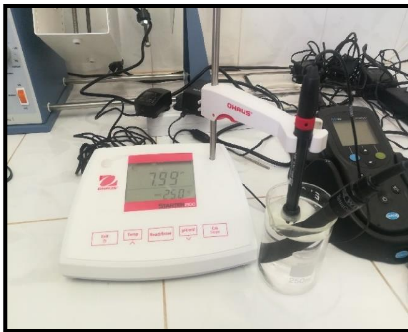
Figure IV.3: Ph-mètre Starter 2100 pH Bench (Photo prise par BENSEDIRA S., 2020)
