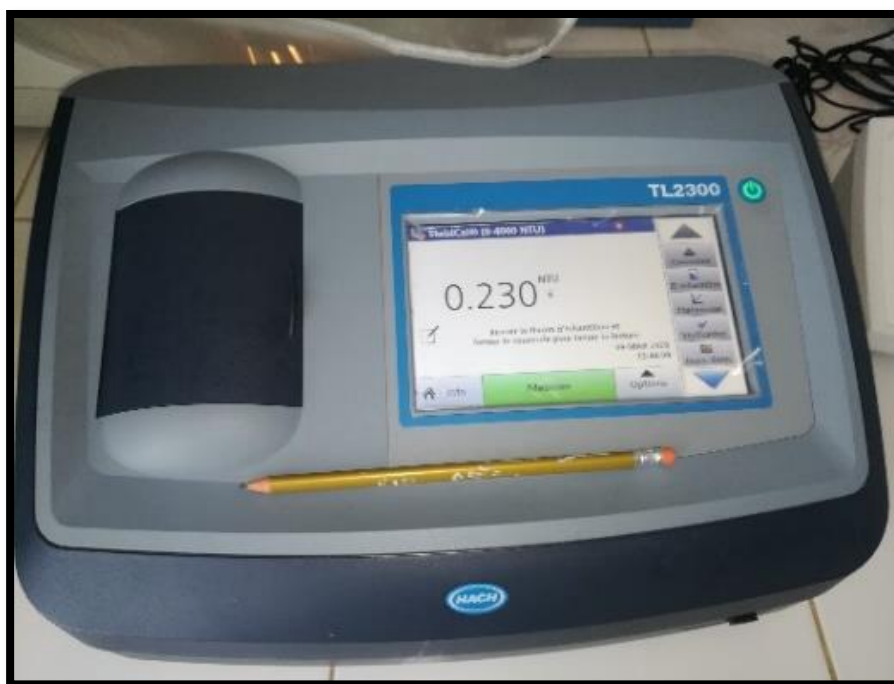
Figure IV.2 : Turbidimètre à lampe au tungstène TL2300, EPA, 0 - 4000 NTU. (Photo prise par BENSEDIRA S., 2020).
