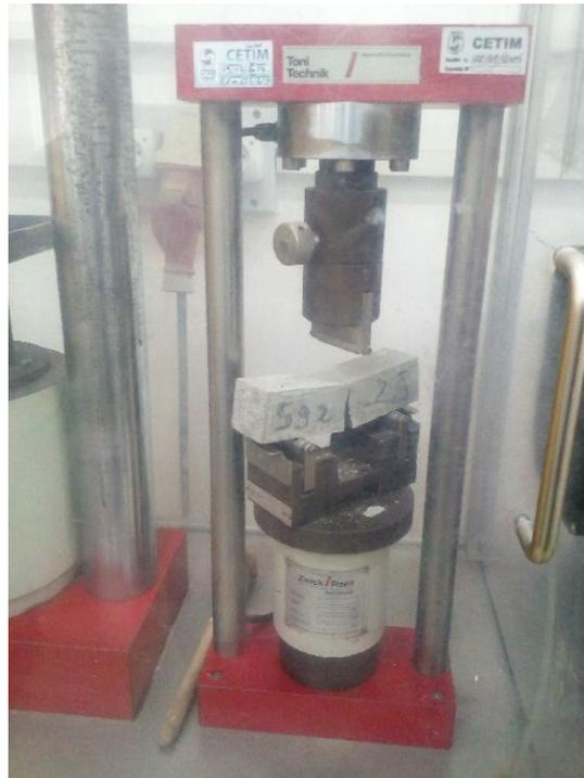
Figure 3-4: Dispositif pour l'essai de résistance à la flexion.
