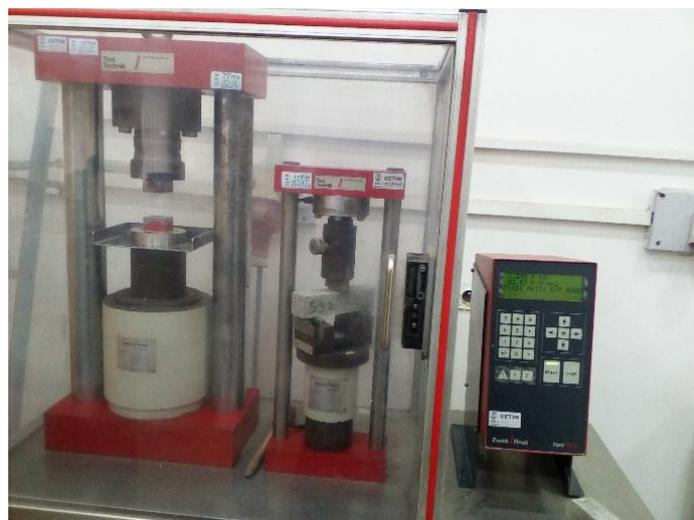
*Figure 3-3: Appareil de compression et de flexion.*
