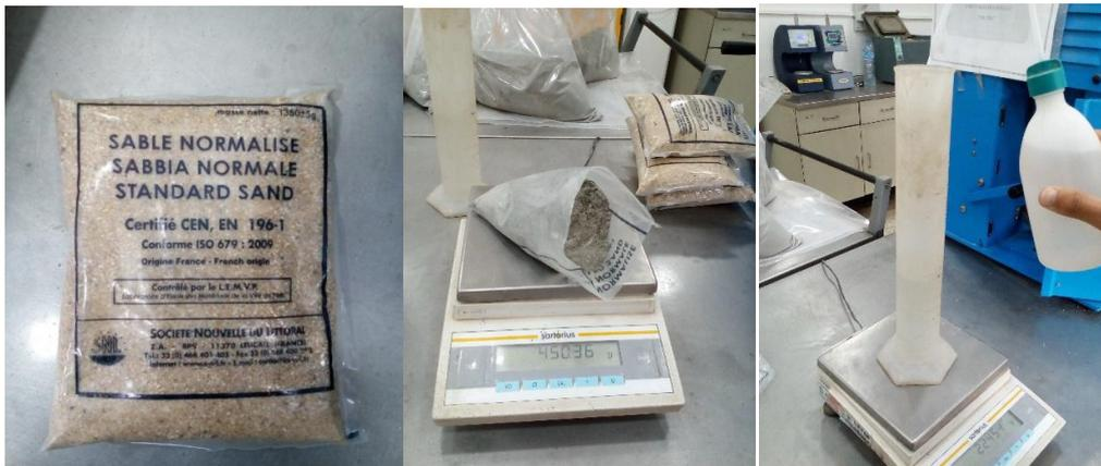
Figure 3-1: Sable normalisé, pesée d'eau et de ciment (respectivement).
