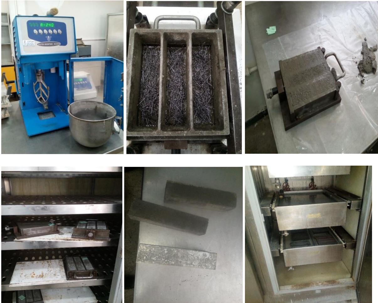
*Figure 3-2: Etapes de préparation des éprouvettes et matériel utilisé : malaxeur, ajout de fibres, Enlèvement de l'excès de mortier, armoire humide, démoulage des éprouvettes, Conservation des éprouvettes dans l'eau (respectivement).*
