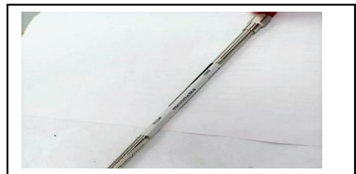
Figure II.4. Colonne C18(5 \mu m), D'une longueur de 25cm, et diamètre Intérieur 4,6mm.
