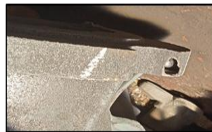
Figure I. 10: Soufflure ou bulle de la pièce
