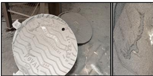
Figure I. 9 : Défaut gale sur la pièce
