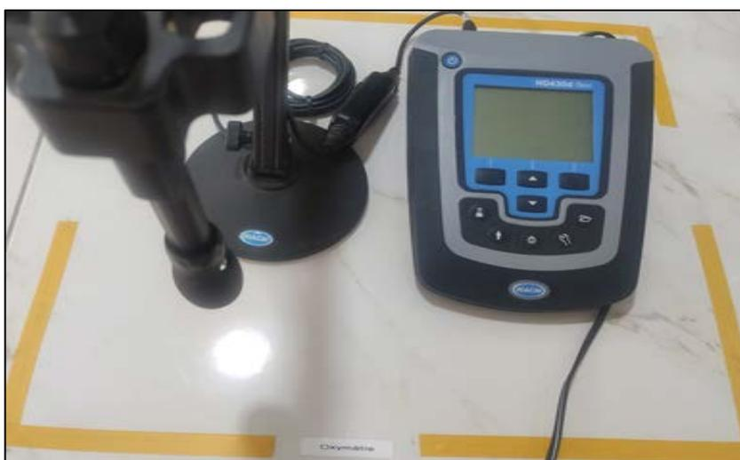
Figure II. 19: Conductimètre
