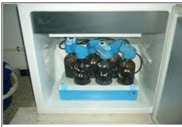
**Figure II. 22:** DBO-mètre
