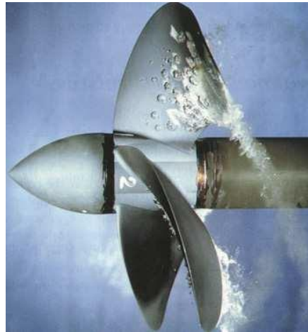
Figure 14: Apparition de bulles de cavitation sur les pales d'une hélice (POMERO, 2002)
