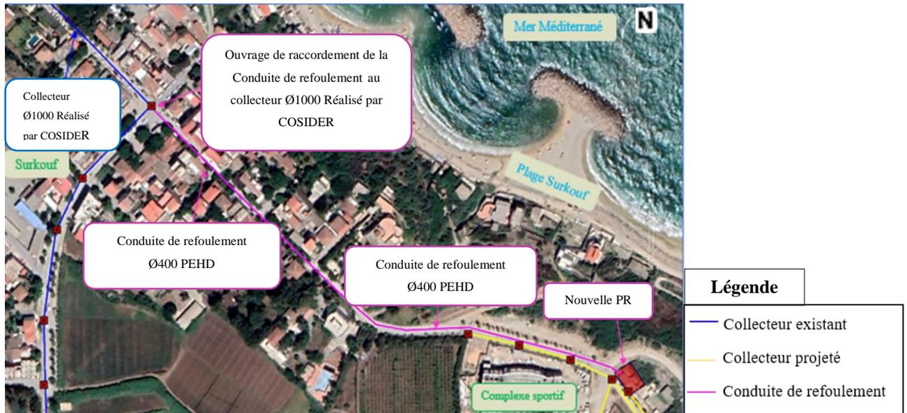
Figure V- 2: Le tracé de la conduite de refoulement
