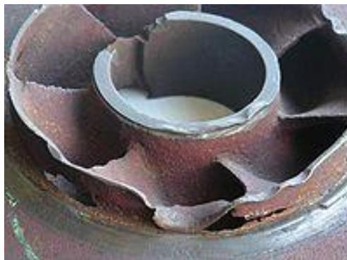
**Figure V- 10:** Pompe centrifuge détruite par la cavitation
