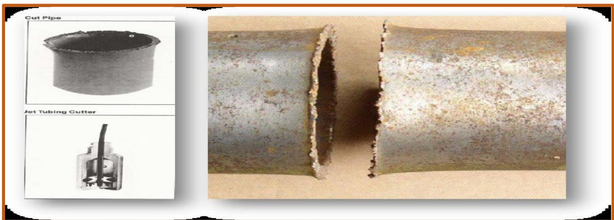
*Figure 34: Coupe à l'explosif (JET CUTTER). [2]*
