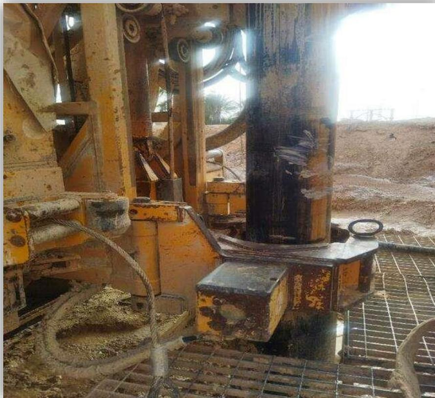
*Figure 41 : Puits P442 HMD lors du coincement tubage.*
