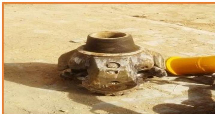
***Figure 15 : l'outil de forage 8<sup>1/2</sup> (Forage Hassi Messaoud).***
