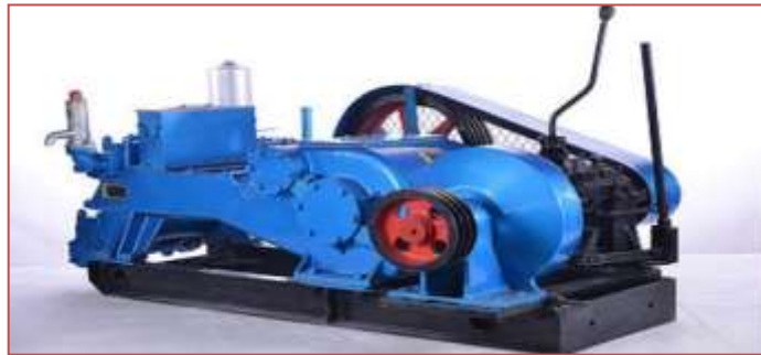
Figure 29 : pompe à boue
