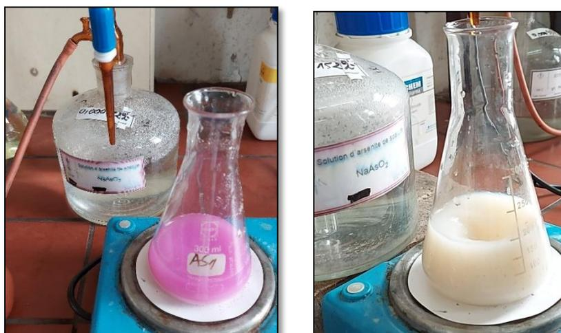
**Figure II.16 :** Solution titrée d'arsénite de sodium jusqu'à disparition de la coloration.
