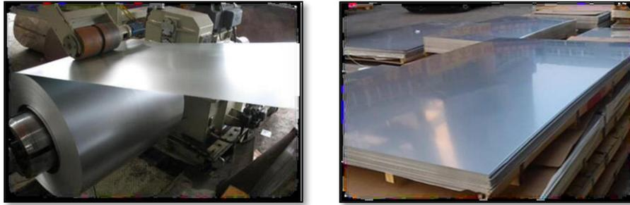
**Figure I.5 :** Bobines et tôles Skin Passées.
