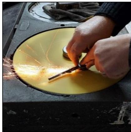
**Figure II.8 :** Polissage de la surface d'échantillon.
