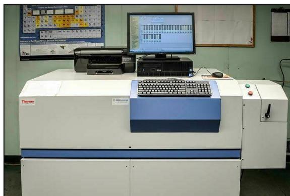
**Figure II.6 :** Spectrométrie à émission optique type ARL3460.
