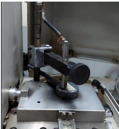
**Figure II.9 :** Échantillon à analyser sur le dispositif à étincelle du spectromètre.
