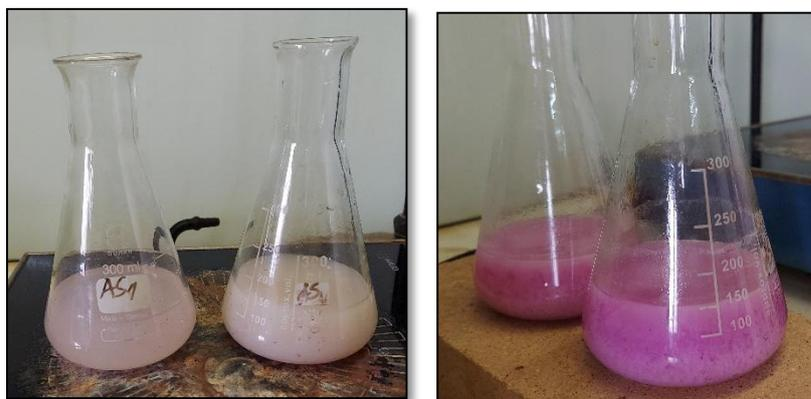
**Figure II.15 :** Ajout de nitrate d'argent et persulfate d'ammonium.
