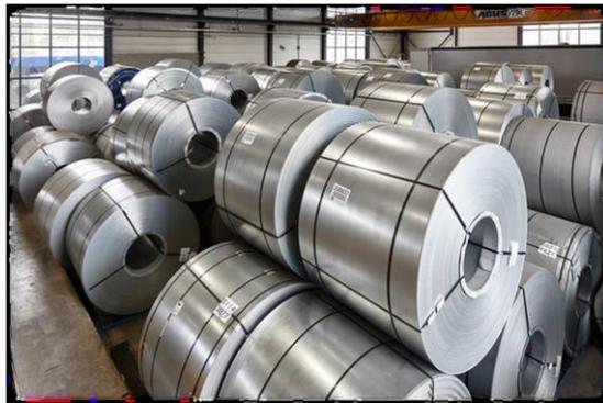
**Figure I.6 :** Bobines Galvanisées.
