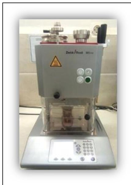
**Figure IV.7.** Appareil d'indice de fluidité
