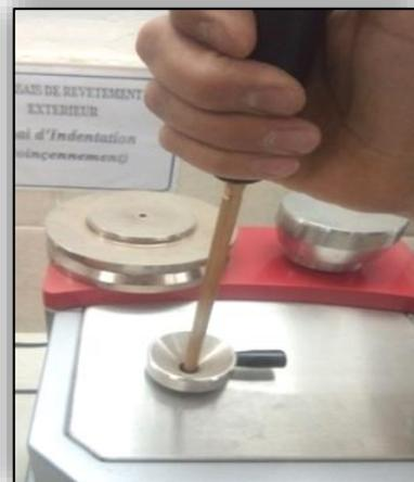
**Figure IV.12.** Remplir le cylindre et presser l'échantillon
