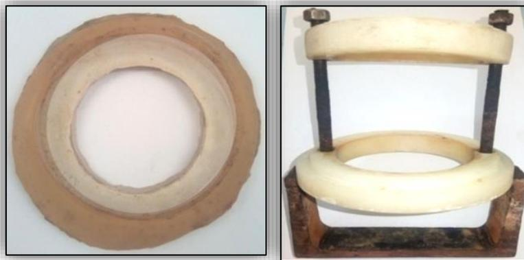
**Figure IV.2.** Support de fixation du cylindre sur l'éprouvette
