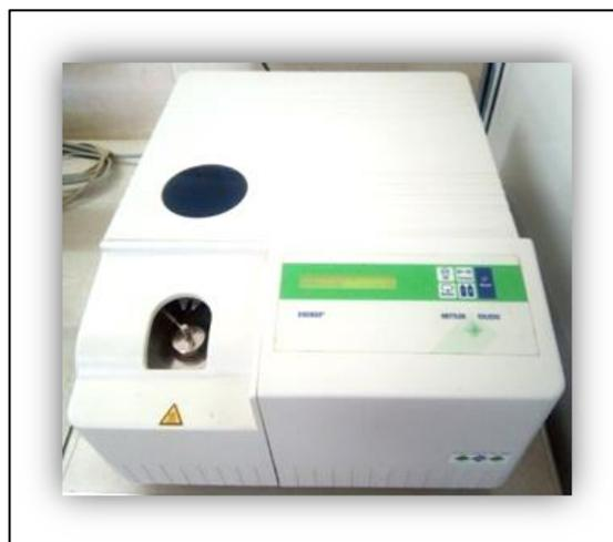
Figure IV.13. Calorimétrie différentielle
