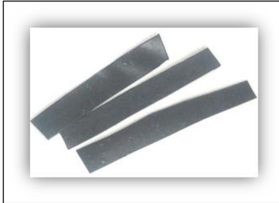
**Figure IV.9.** Coupons de PEHD extrudé
