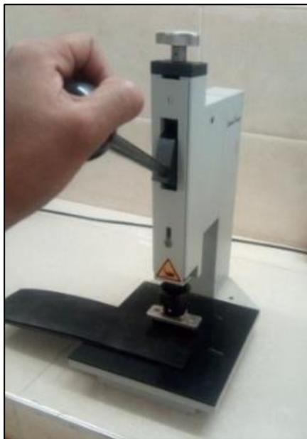
**Figure IV.19.** Découpage des éprouvettes de traction
