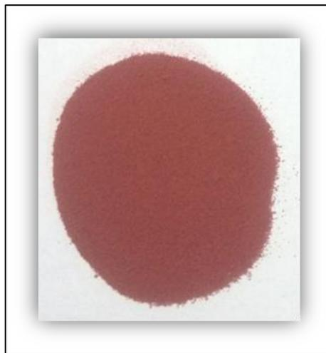
**Figure IV.14.** Echantillon d'époxy poudre
