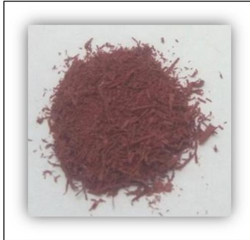
**Figure IV.15.** Echantillon de filme polymérisé après broyage
