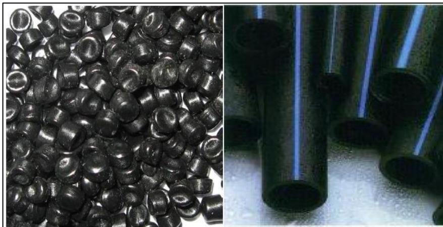
**Figure II .2 :** Matière première PE sous forme de granulés et tube PEHD [18].
