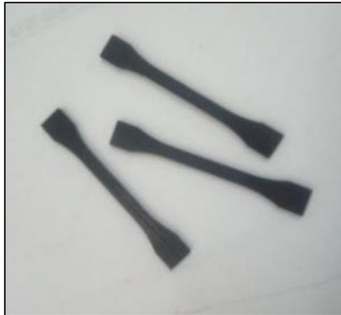
**Figure IV.18.** Éprouvettes de traction
