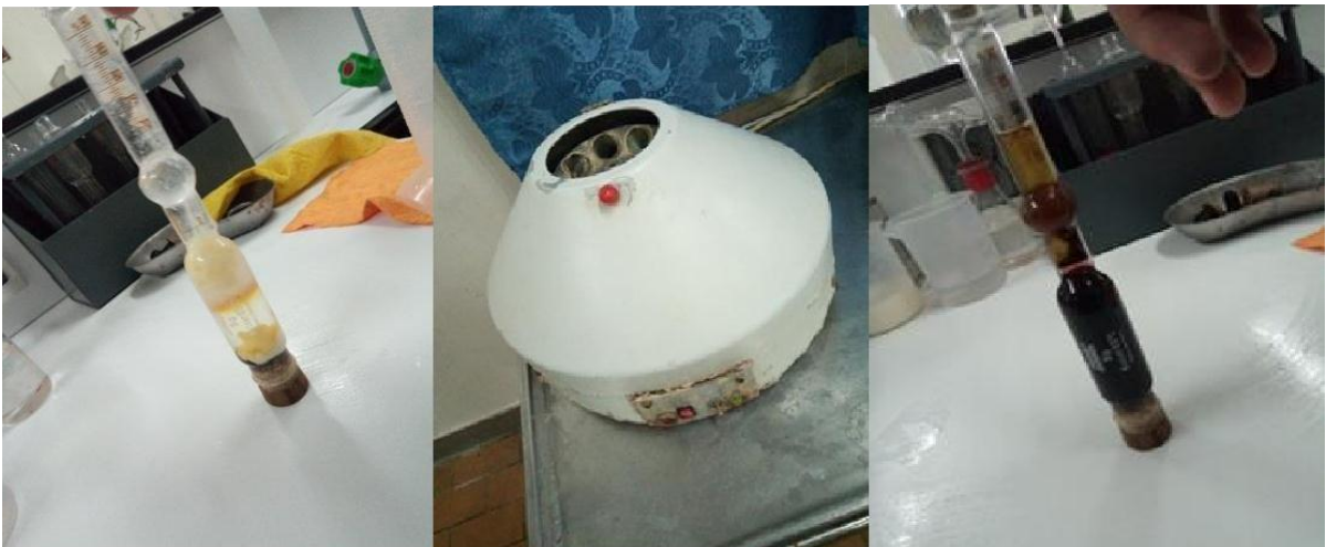
Figure III. 19 : (1) le butyromètre avant, (2) la centrifugation, (3) le butyromètre après.
