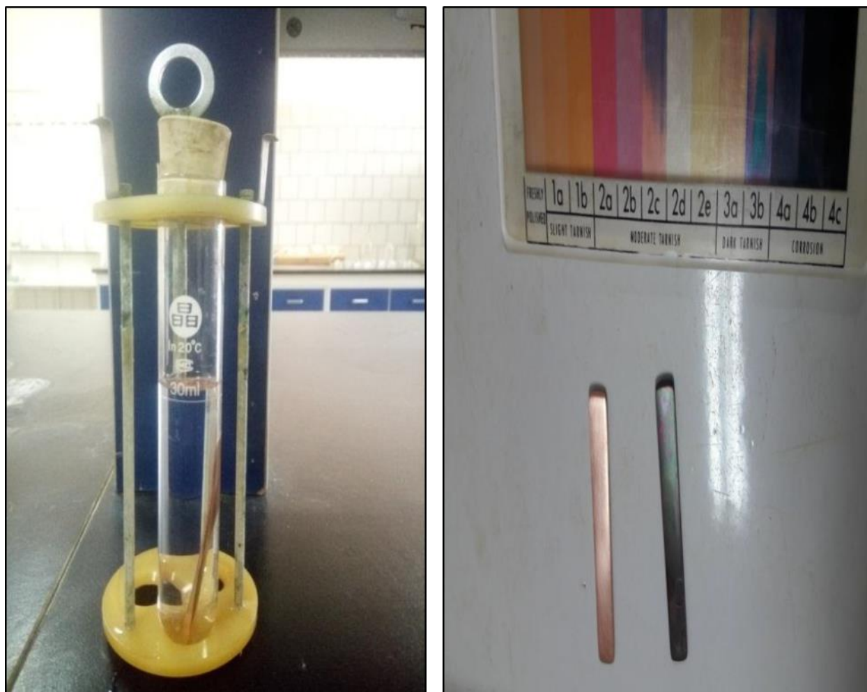
Figure III.9 : Préparation et résultat d'essai de la lame du cuivre.
