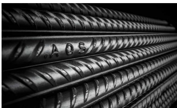
Figure I-11 : Rond à béton.
